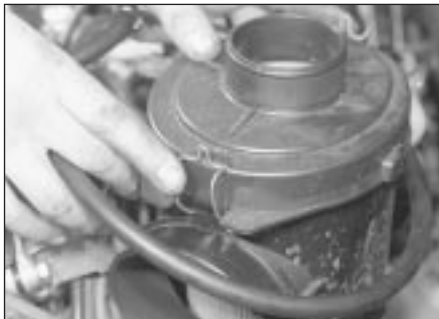
28.5a Prise down the toggle clips . . .
