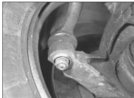
13.2a Loosen the balljoint nut . . .
